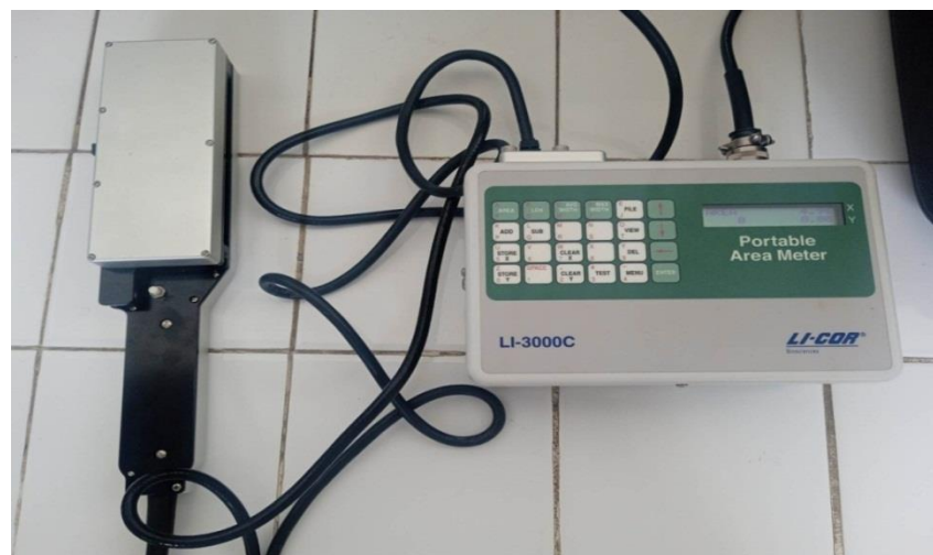
Figure 10 : Appareil de mesure de la surface foliaire Portable Area Meter (LI-3000C)
