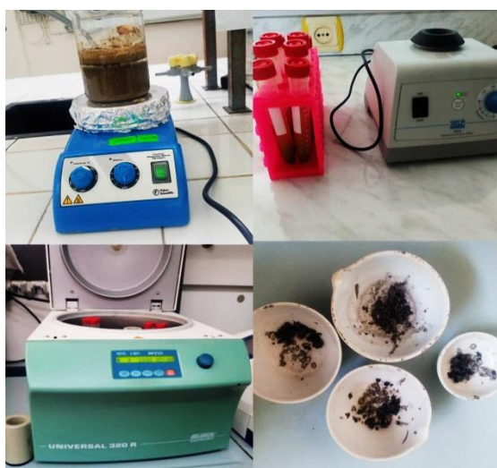
Figure 11 : Les différentes étapes d'extraction de ZnO
